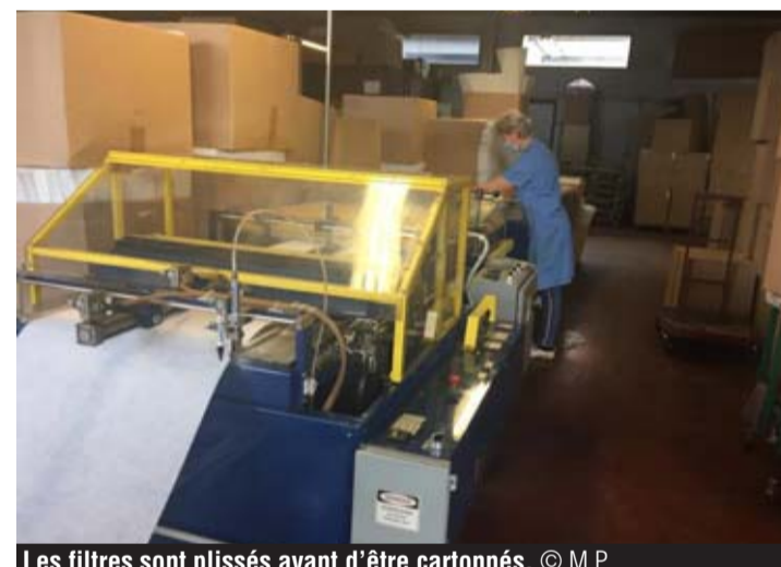
Les filtres sont plissés avant d'être cartonnés. © M.P.
